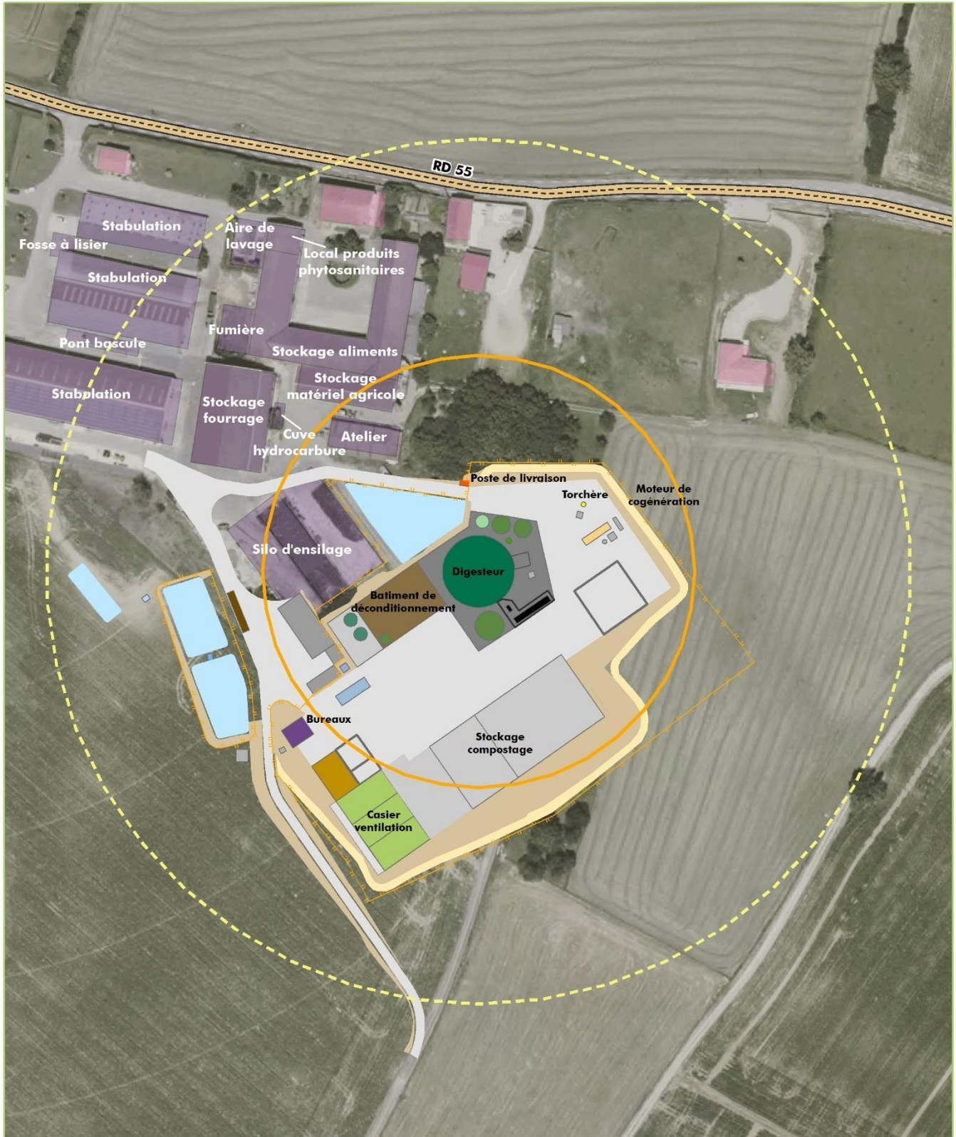
Illustration 12 : Effets de surpression pour le scénario 3 : Explosion UVCE suite à la ruine du gazomètre Source : L'Artifex
